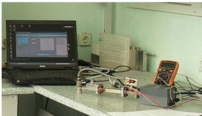
Рисунок 4.6 – Зовнішній вигляд вимірювача НВЧ вологості -1 та керуючого ПК і система з'єднань
