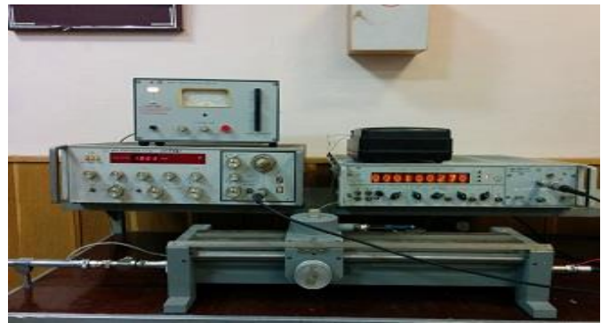
Рисунок 2 – Структурна схема вимірювальної установки (а) та її загальний вигляд (б): НЧ-невзаємний чотириполіусник, К1 – перший комутатор, К2 – другий комутатор, G – генератор, W – ватметр, \alpha - вентель
