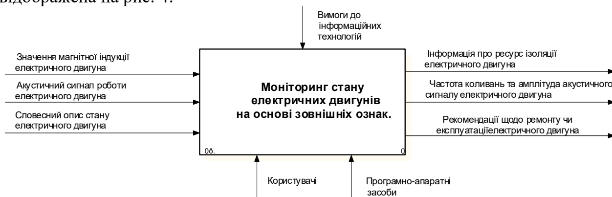
Рисунок 4 – Контекстна діаграма процесу моніторингу АД на основі зовнішніх ознак
