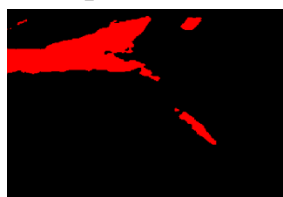
д) Поріг зображення. Використаний інструмент «Threshold a Grayscale Image» з параметрами (Manual Threshold: Bright Object)
