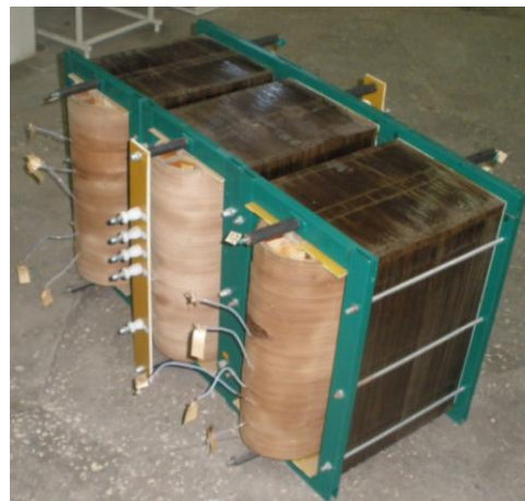
Рисунок 7 – Трифазний трансформатор з просторовою магнітною системою з горизонтальним розташуванням фаз
