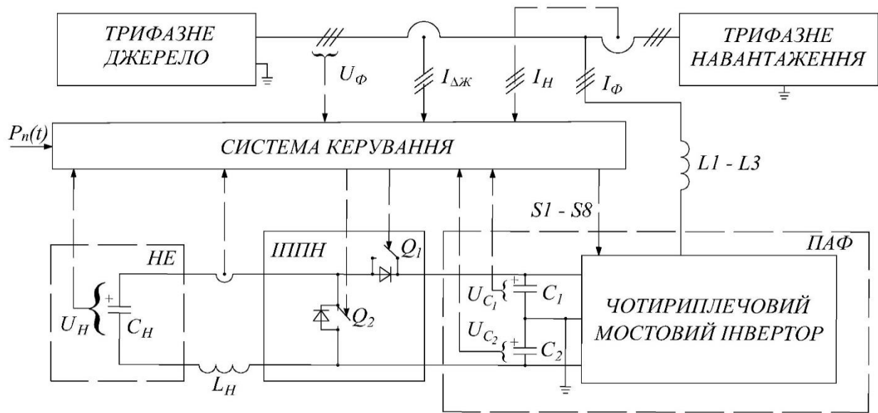
Рисунок 4.10 – Структурна схема фільтраційної системи з додатковою системою накопичення енергії та системою управління та регулювання
