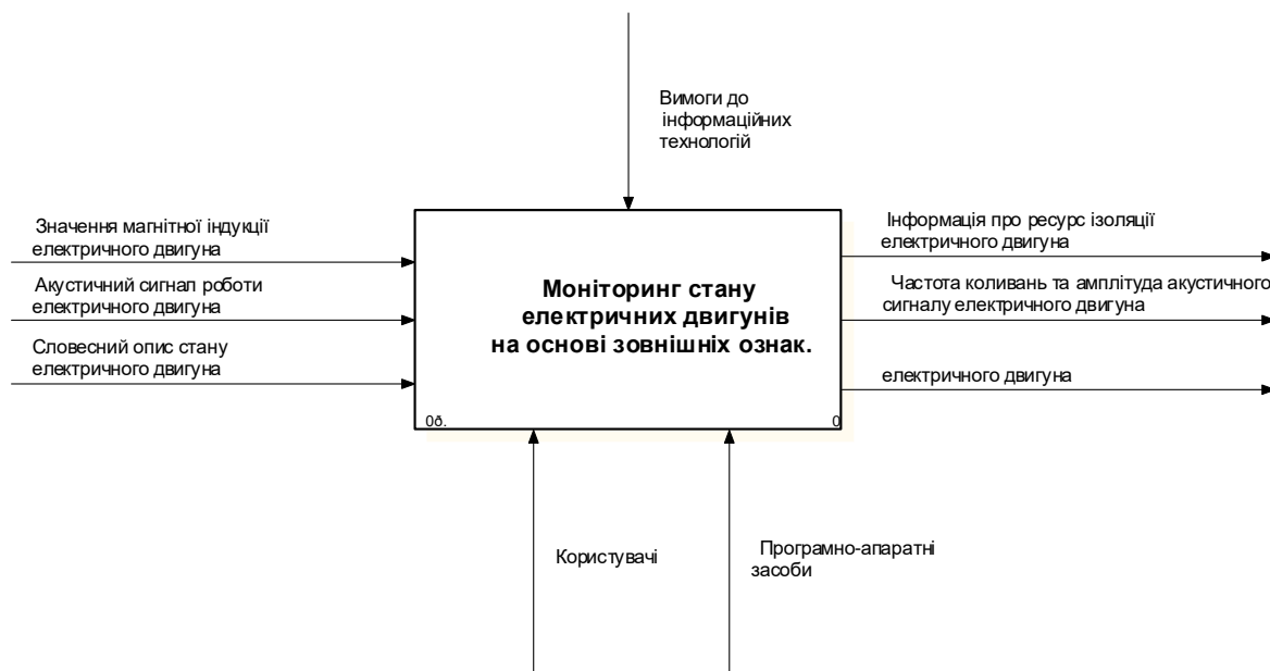
Рисунок 4.1 – контекстна діаграма процесу моніторингу стану електричних двигунів на основі зовнішніх ознак
