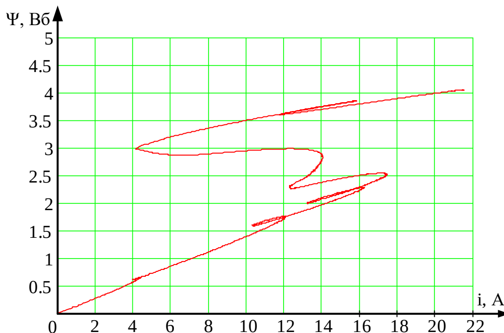
Рисунок 4.14 – Вебер-амперна характеристика обмотки вимкнення електромагніту вакуумного вимикача
