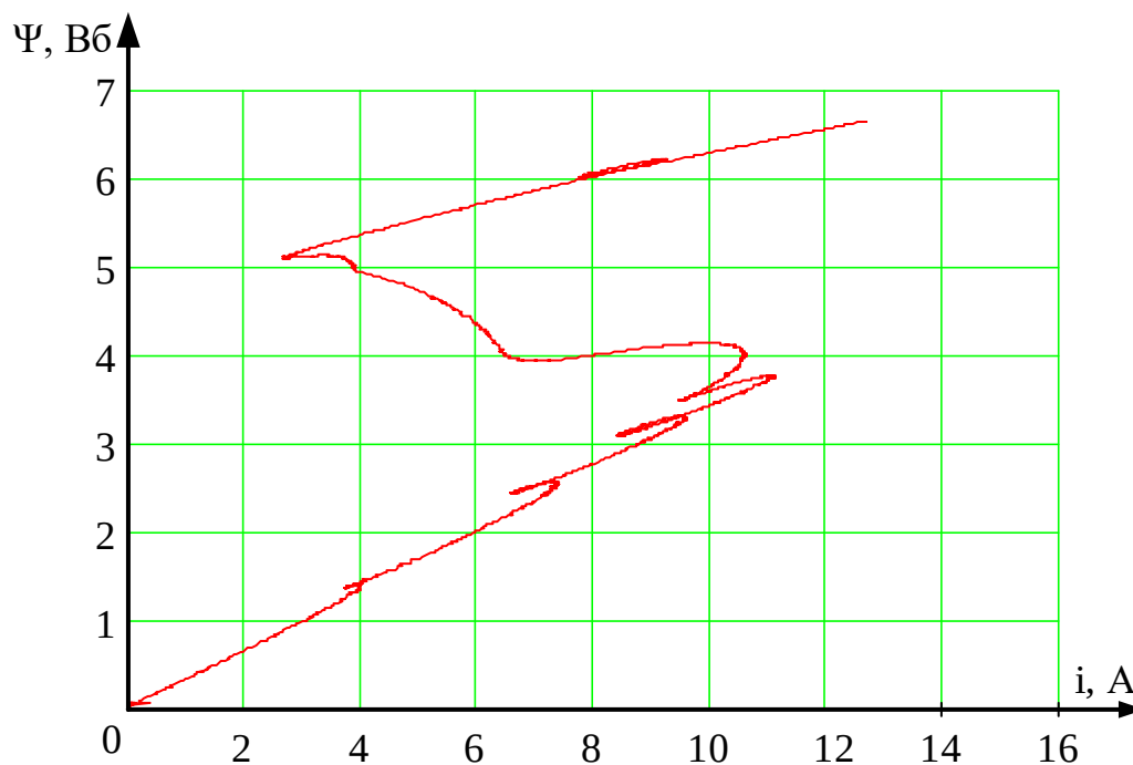
Рисунок 4.15 – Вебер-амперна характеристика обмотки ввімкнення електромагніту вакуумного вимикача
