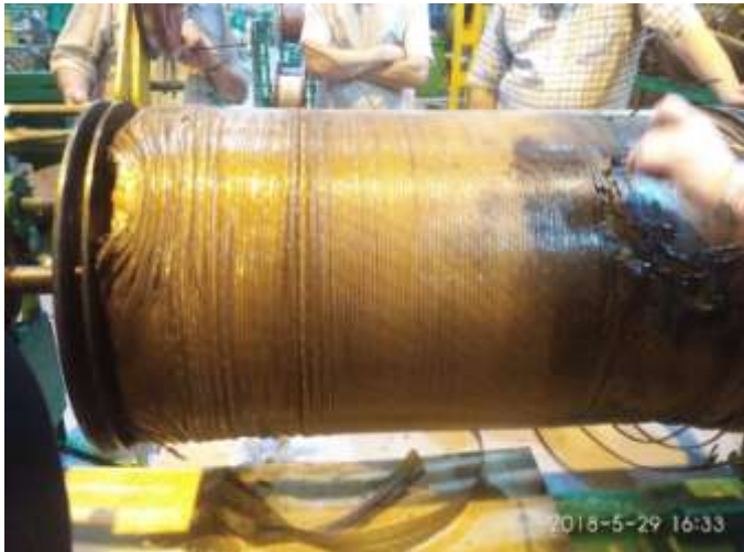
Рисунок 1.12 – Фото обмотки силового трансформатора 10/0,4 кВ
