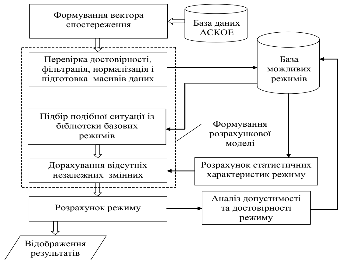
Рисунок 3.1 – Блок-схема алгоритму визначення параметрів поточного режиму
