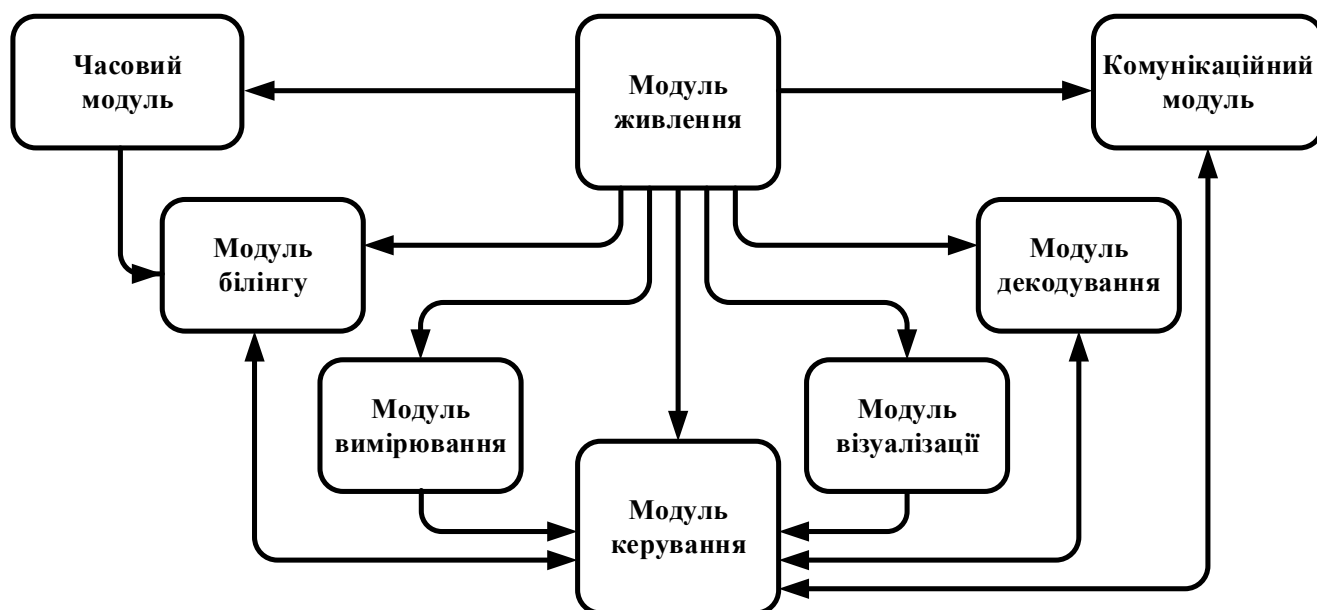
Рисунок 1.2 – Діаграма функціонування приладу Smart Metering
