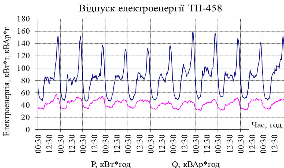
Рисунок 4.3 – Графіки відпуску електроенергії для промислових ТП-543 (а) та комунально-побутових ТП-458 (б) споживачів
