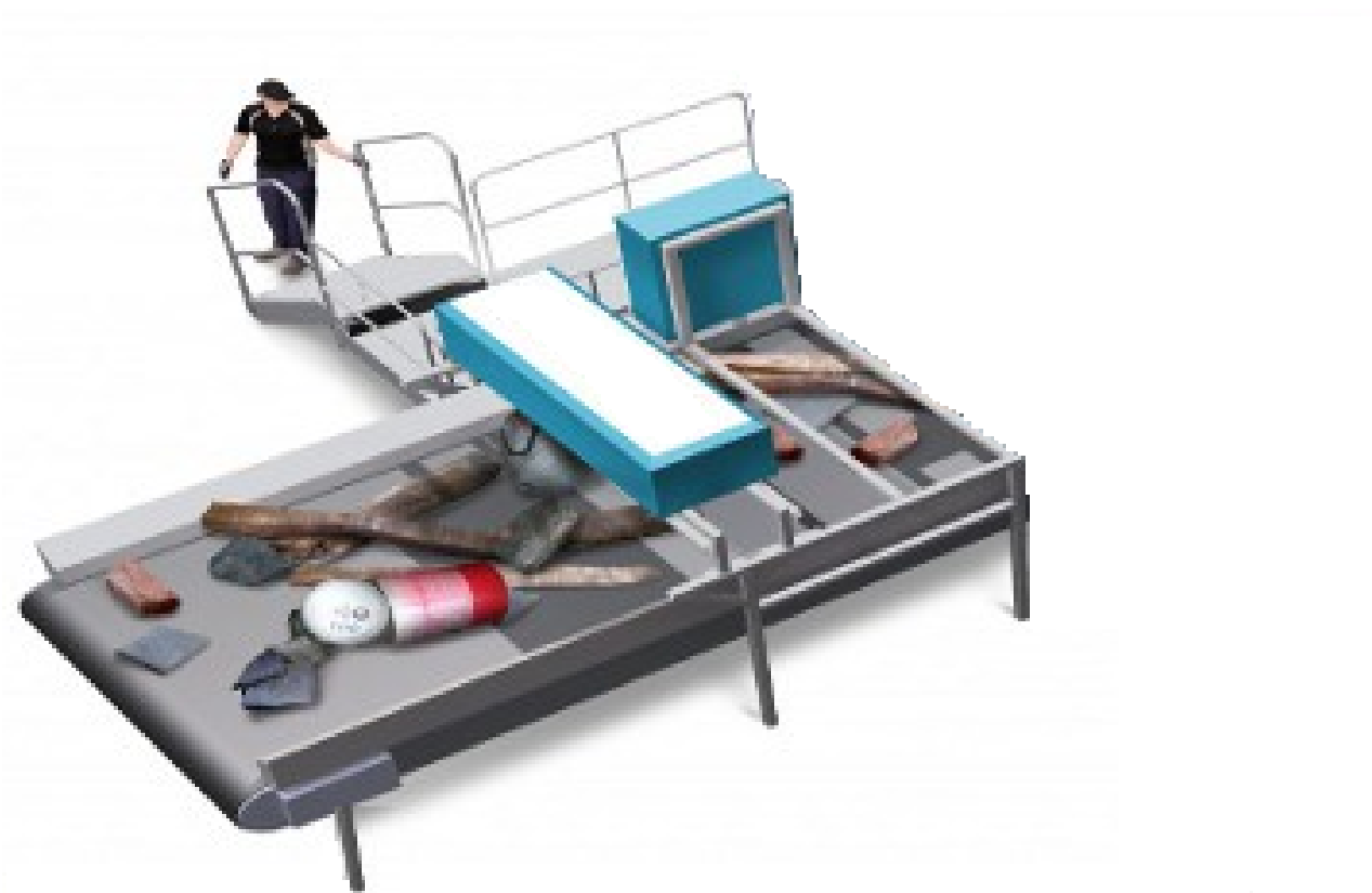
Рис.3.2 – Фрагмент технологічної установки сортування ТПВ – стрічковий конвеєр та панель з постійним магнітом
