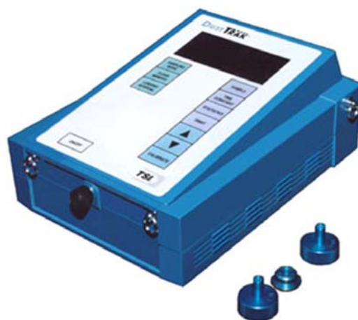
Рисунок 1.1 – Зовнішній вигляд аналізатора аерозолі Dust Trak мод. 8520
