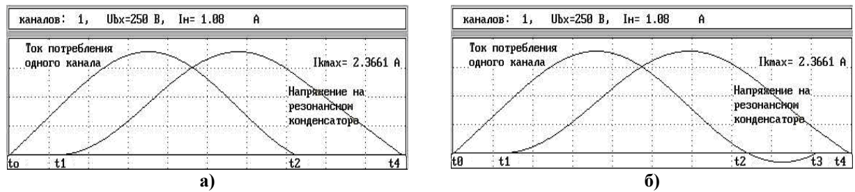
Рис. 2. Временные диаграммы тока i(t) дросселя L и напряжения u_C(t) на конденсаторе C резонансного контура для однополупериодного (а) и двухполупериодного (б) режимов работы
